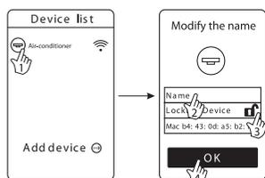
Если у вас заблокированное устройство, вы должны разблокировать устройство прежде чем подключать другие телефоны. Если моб.телефон, с которого было заблокировано устройство пропал, Вы должны перезагрузить Wi-Fi модуль, только после этого вы можете использовать новый моб.телефон для соединения с устройством.
