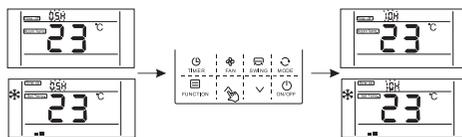
После настройки функции «Timer On» вы можете регулировать скорость вентилятора, режим работы, заданную температуру и угол поворота. Если в течение 10 секунд не выполняется никаких действий, отобразится экран режима ожидания.
