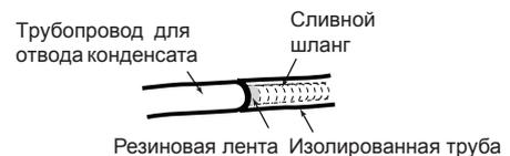
3. Обмотайте теплоизоляцию изолентой для предотвращения повреждения и соскальзывания. На поверхности неизолированной трубы может образовываться конденсат.
